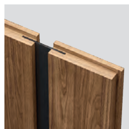
spojení se sklem „na hranu“ polodrážkové křídlo
